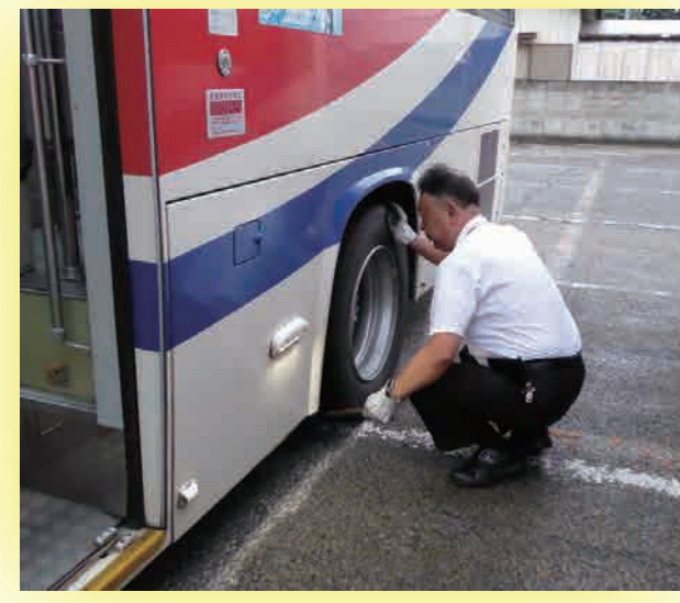
タイヤに異常はないか特別なハンマーで点検します
